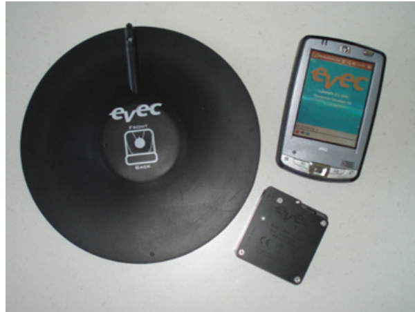
Figure 5 : Système EVEC pour vibrations globales du corps (in English)
